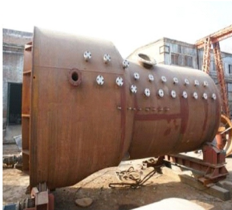
甲烷二氧化碳重整反应器 ( \phi 2.6\text{m} )
